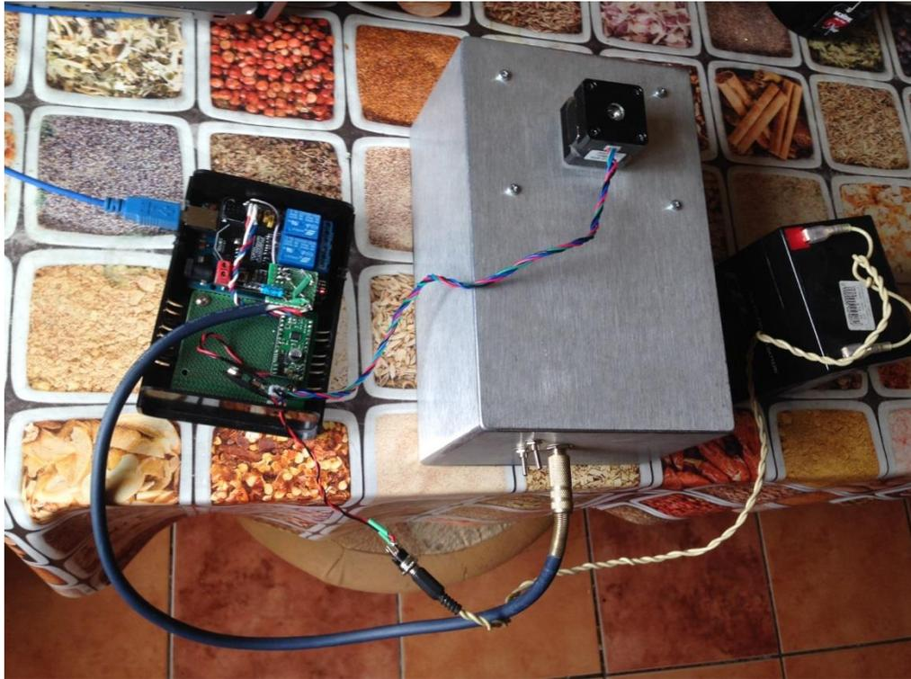
**Рис. 15.** *Общий вид установки. Измерительная часть находится внутри металлического корпуса. Снаружи контроллеры и системы связи.*
