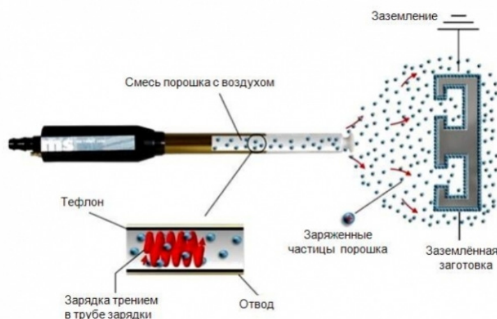
Рис. 2. Трибоэлектрический способ зарядки краски
