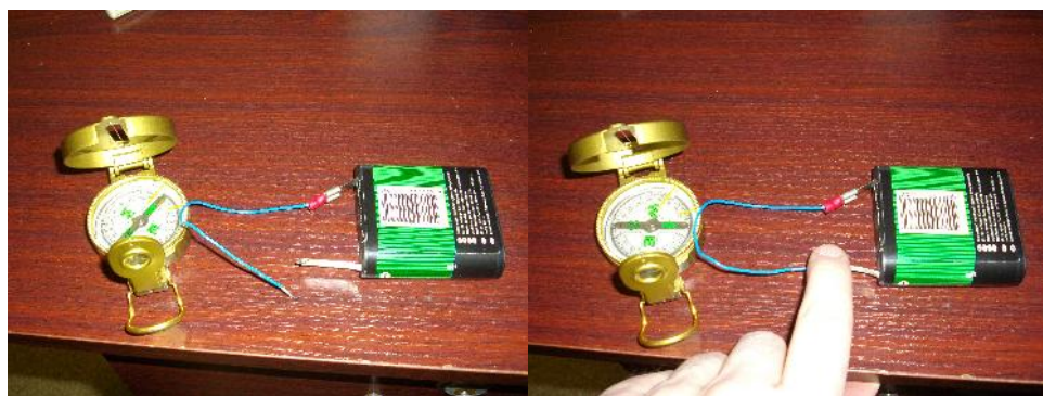
Рис. 2. Отклонение стрелки компаса током порядка 2А (опыт Ампера)
