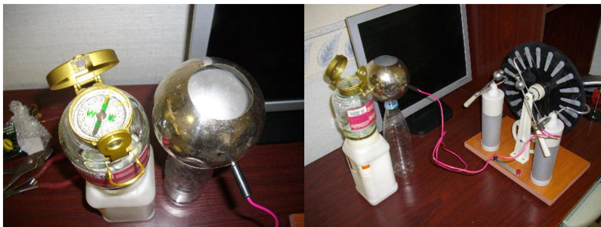
Рис. 4. Эксперимент. Стрелка компаса вблизи заряженного до потенциала 100 кВ шара не отклоняется.
