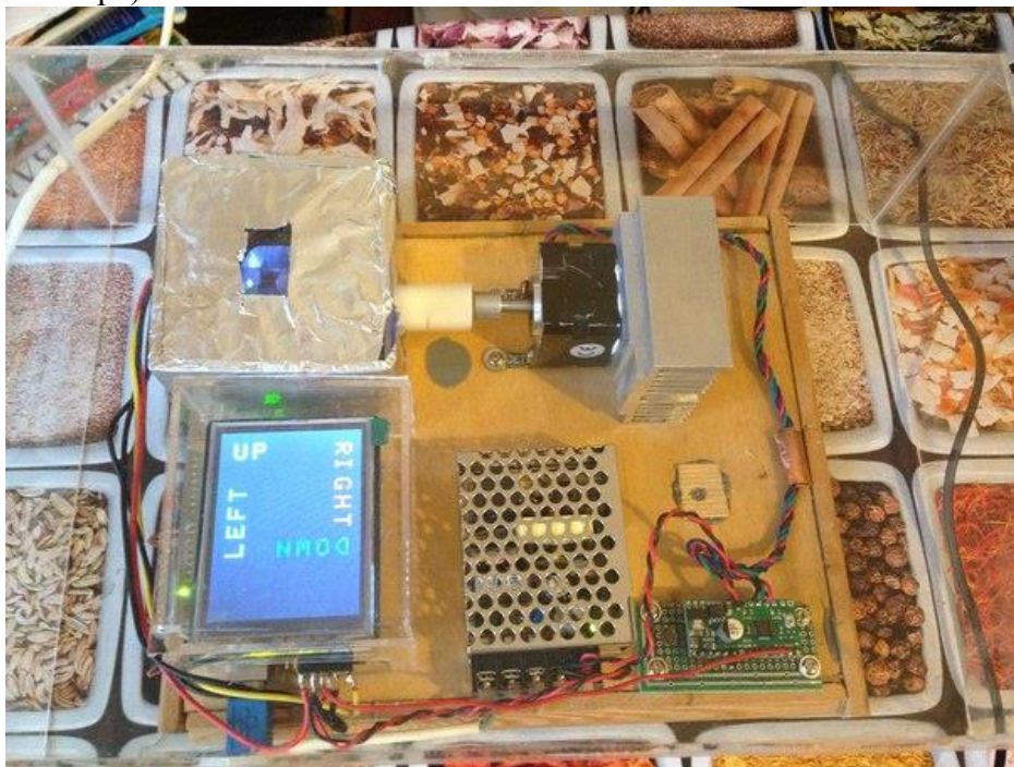
Рис. 8. Измерительный мост в кожухе с экраном и вся измерительная часть установки под общим прозрачным колпаком
