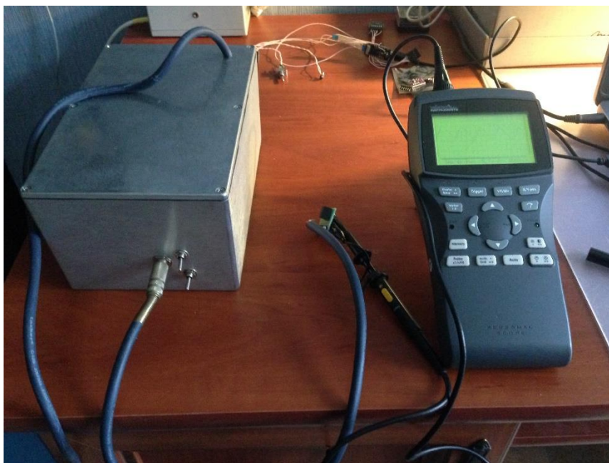
Рис. 6. Фотография установки. Вся электроника вместе с экранированной лампой смонтированы в глухом алюминиевом корпусе (слева). Питание электроники (кроме лампы) батарейное.
