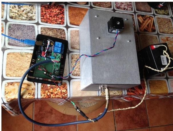
Рис. 4. Установка, использовавшаяся ранее для исследования электрического поля вокруг вращающихся магнитов.
