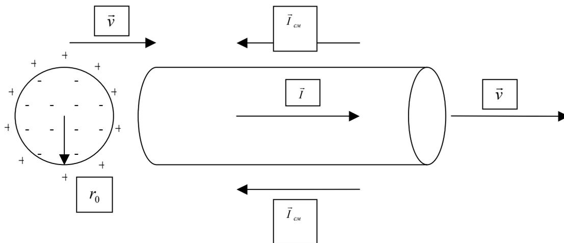
**Рис.1** Движущийся электрон, связанные с его движением токи и их магнитные поля
