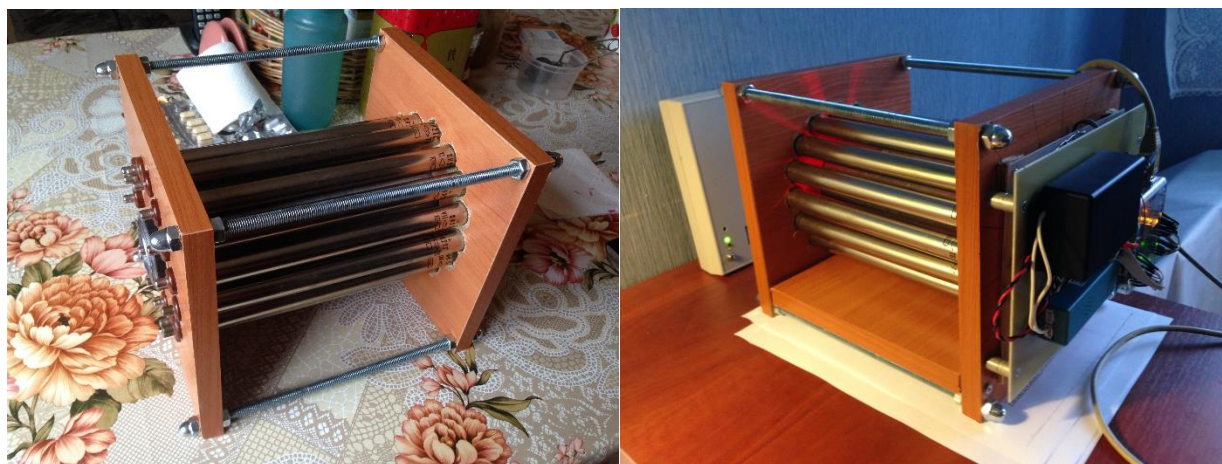
Рис. 3. Револьверный годоскоп. Слева блок датчиков, справа – в сборе с электроникой.
