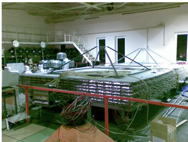
Рис. 2. Мюонный исследовательский годоскоп.
